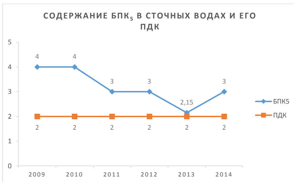
Рисунок 3.2.4.1 Содержание БПК 5 в сточных водах на выпуске из биологических очистных сооружений д. Устье.
