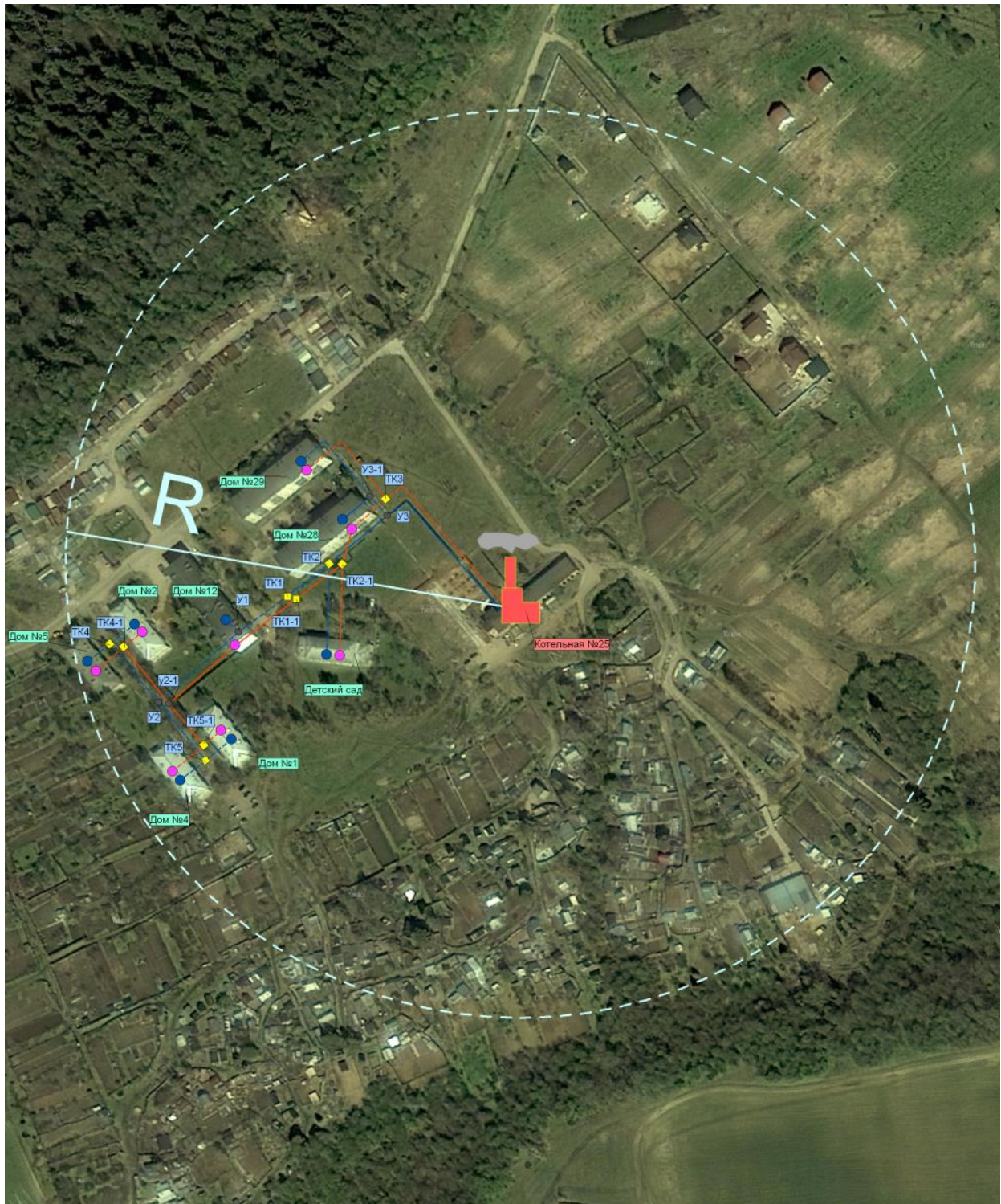
Рисунок 2.8. Радиус эффективного теплоснабжения котельной №25.
