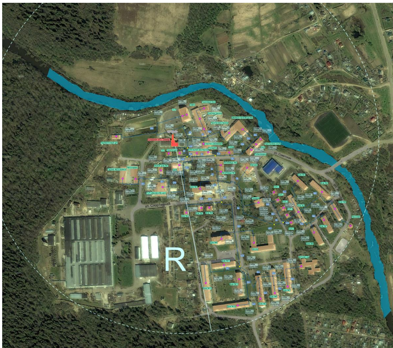
Рисунок 2.11. Радиус эффективного теплоснабжения котельной ЗАО «ЗЭИМ Элинар».
