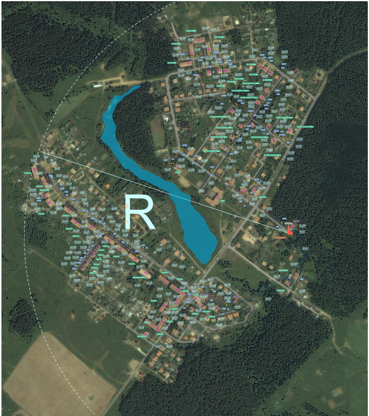
Рисунок 2.7. Радиус эффективного теплоснабжения котельной №45.
