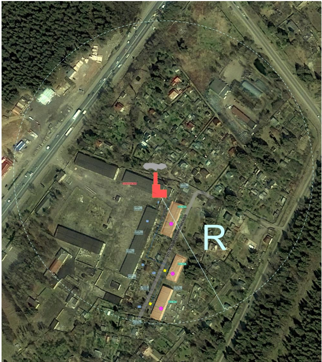
Рисунок 2.10. Радиус эффективного теплоснабжения котельной №40.
