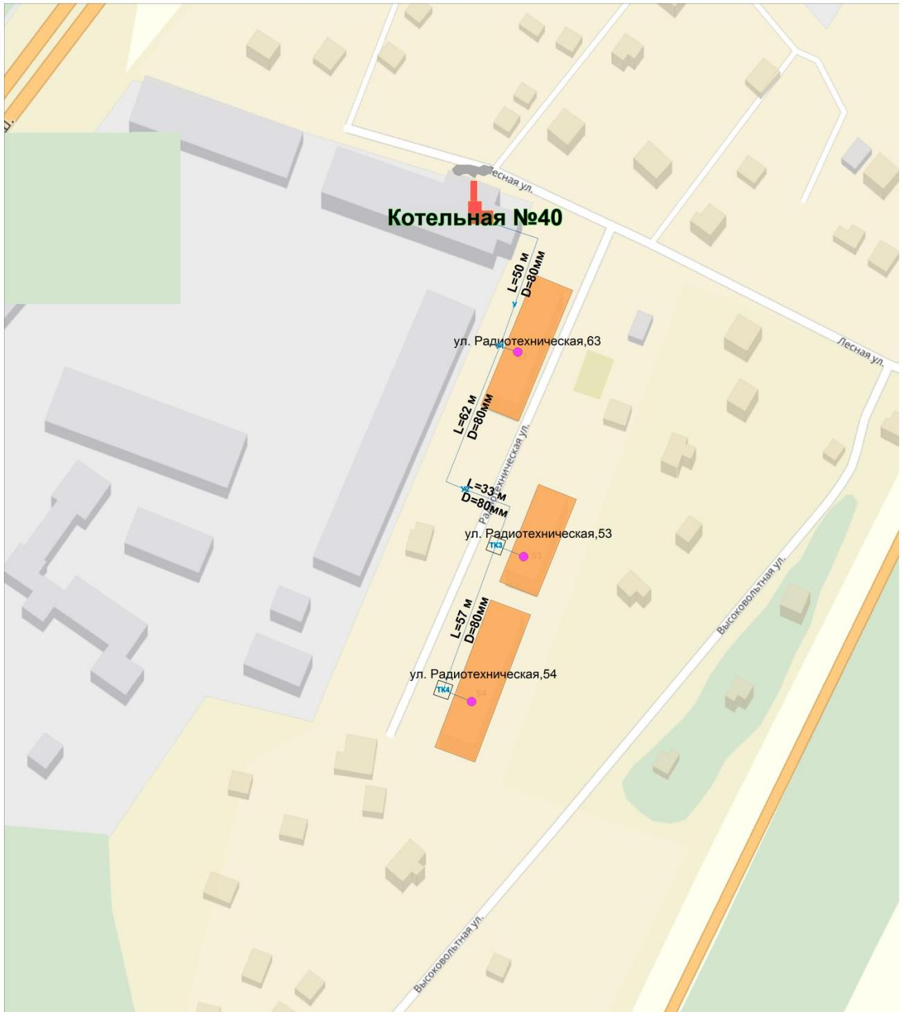
**Рисунок 3.1.7 - схемы тепловых сетей котельной №40**
