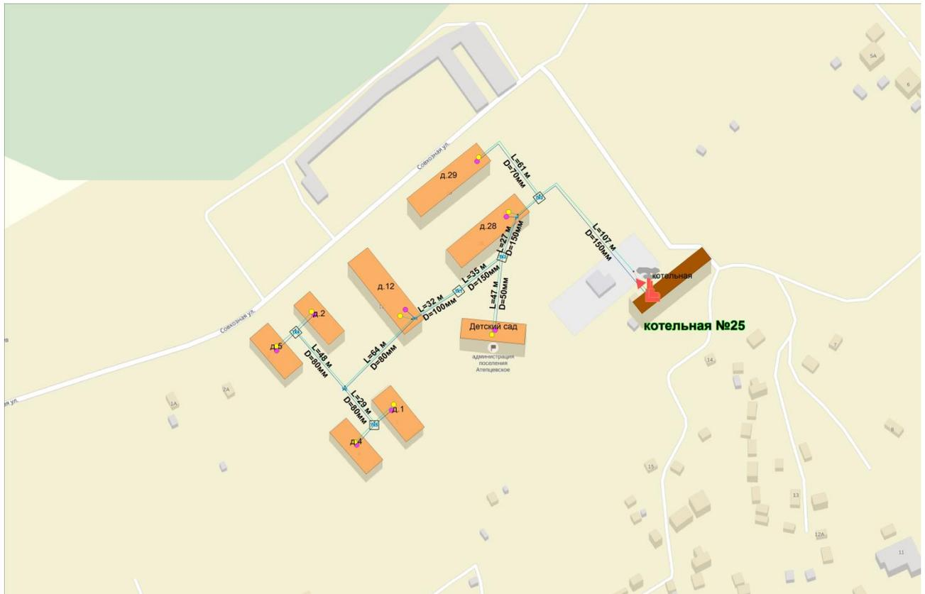
Рисунок 3.1.5 - схемы тепловых сетей котельной №25
