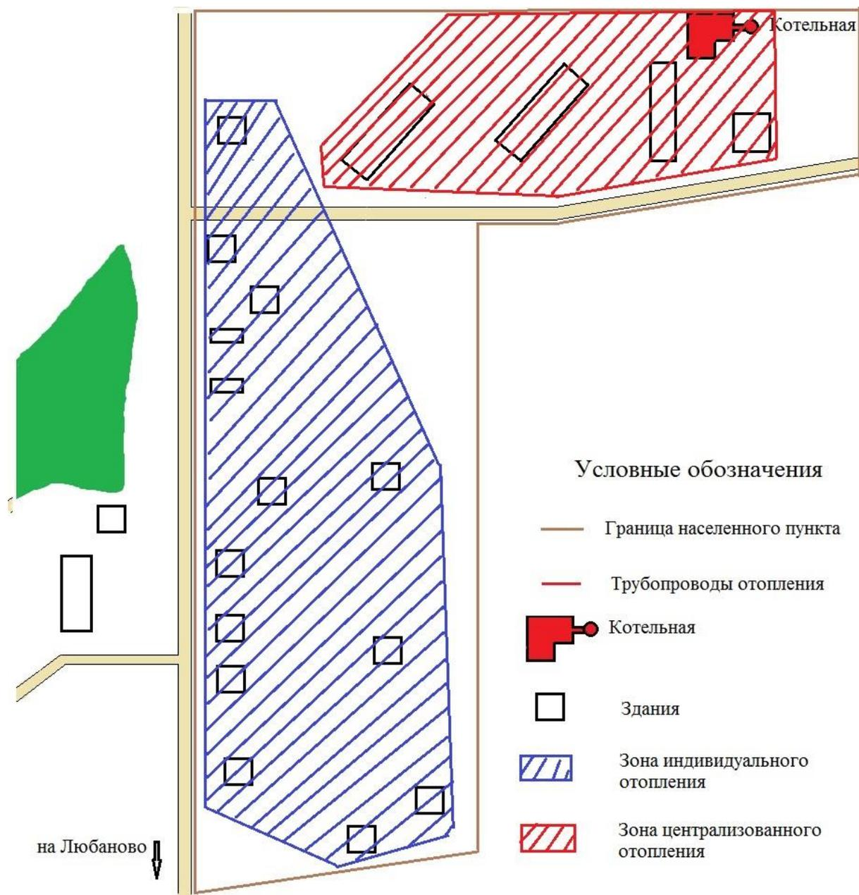
Рисунок 2.17. Зоны действия системы теплоснабжения деревни Мякишево.
