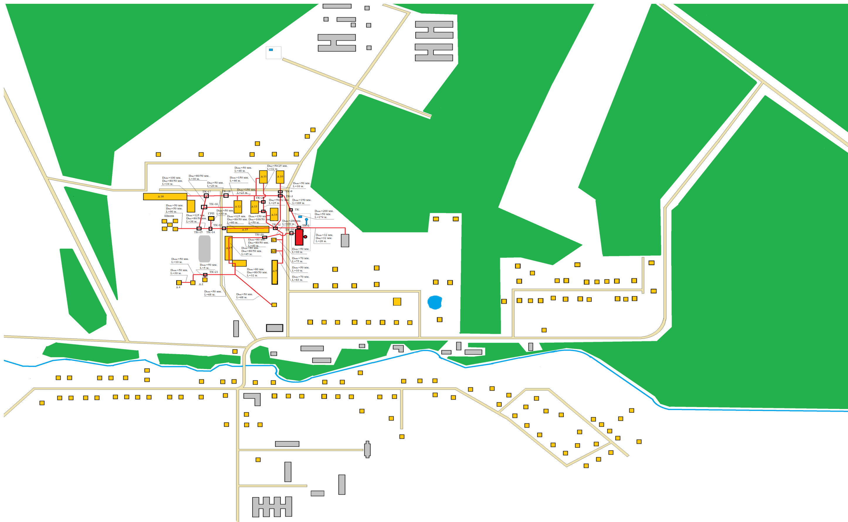
Рисунок 2.26. Схема расположения тепловых сетей в зоне действия источника теплоснабжения деревни Таширово.
