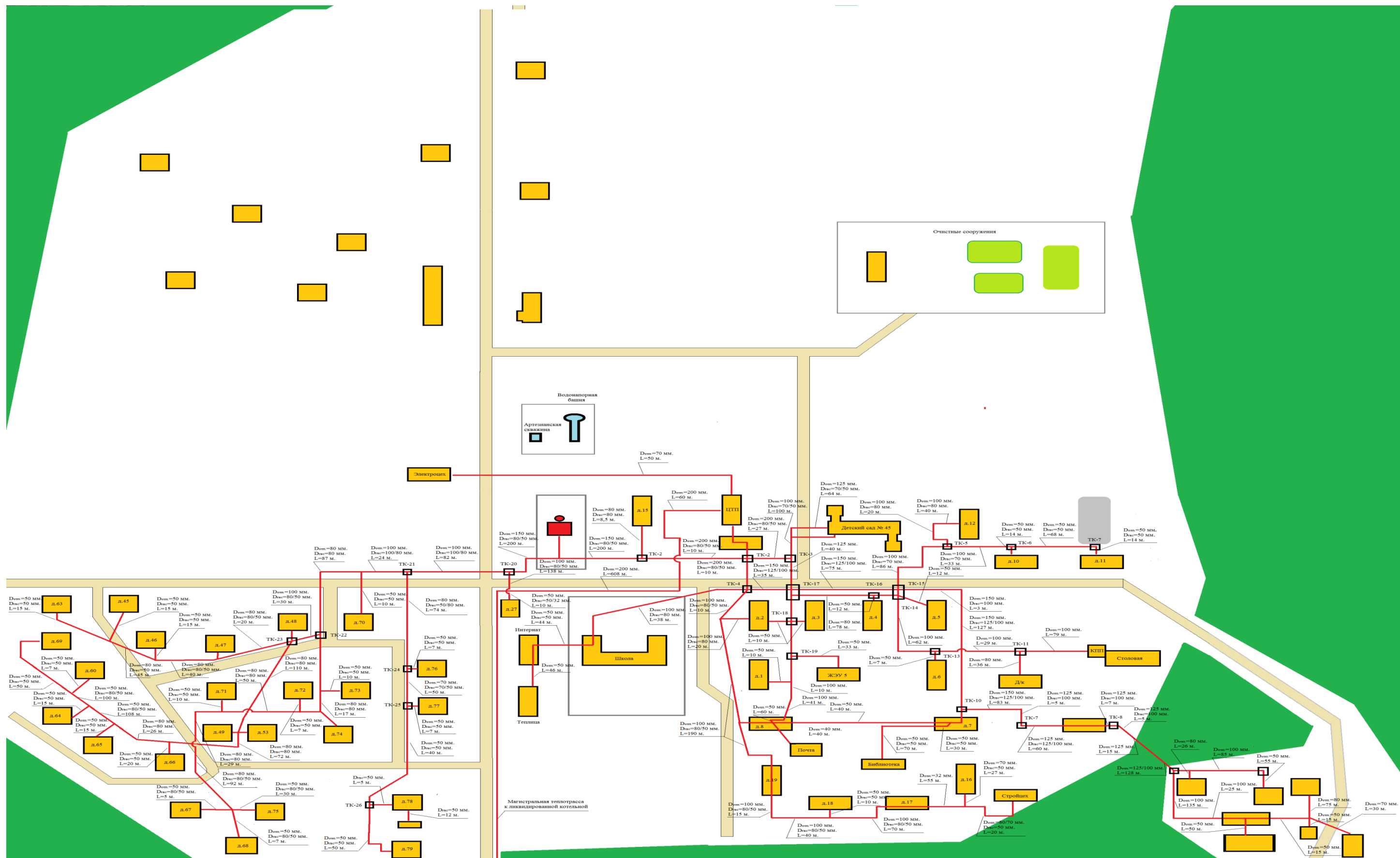
Рисунок 2.27. Схема расположения тепловых сетей в зоне действия источника теплоснабжения деревни Головково.
