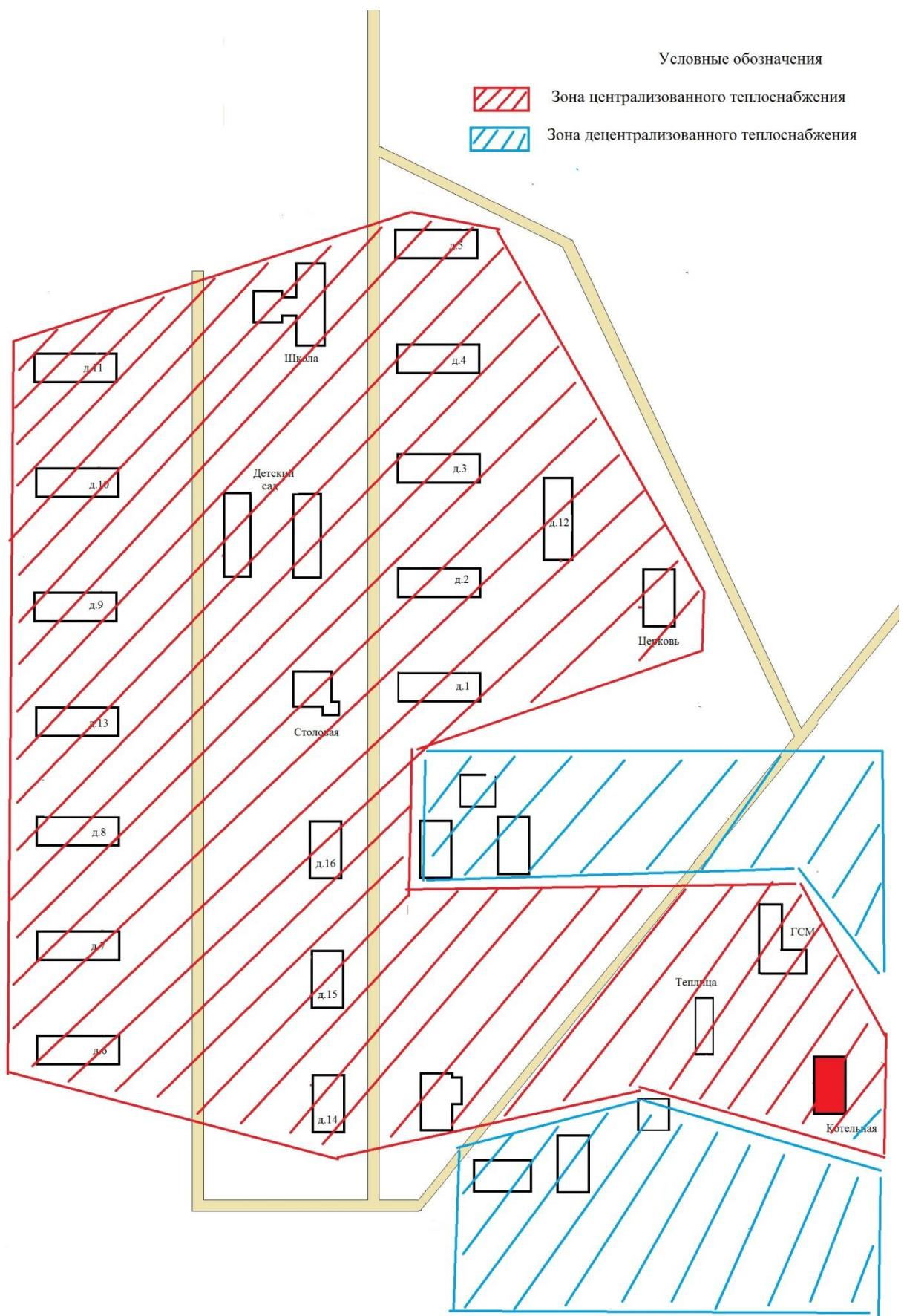
Рисунок 2.15. Зоны действия системы теплоснабжения жилого городка № 12.
