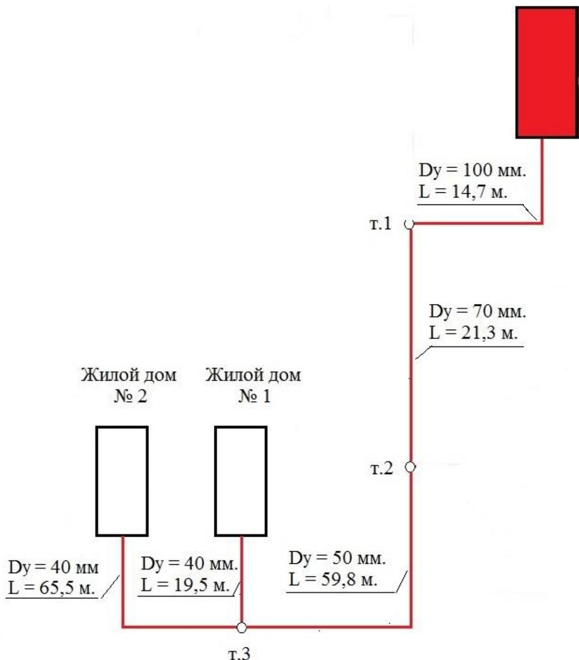
Рисунок 2.21. Схема тепловых сетей в зоне действия централизованного источника теплоснабжения деревни Мякишево.
