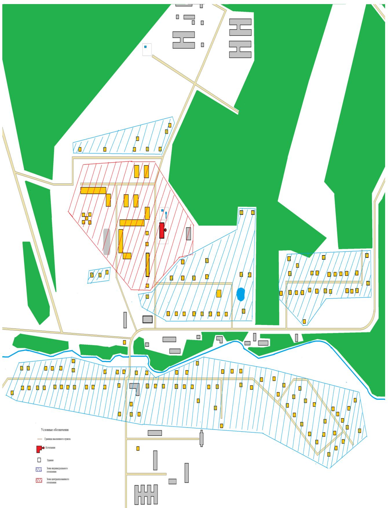
Рисунок 2.14. Зоны действия системы теплоснабжения деревни Таширово.
