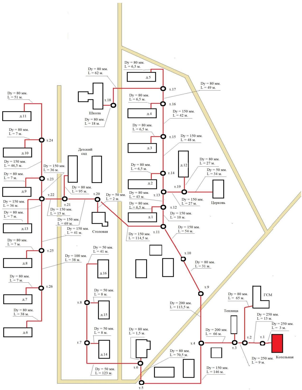
Рисунок 2.19. Схема тепловых сетей в зоне действия централизованного источника теплоснабжения жилого городка № 12.
