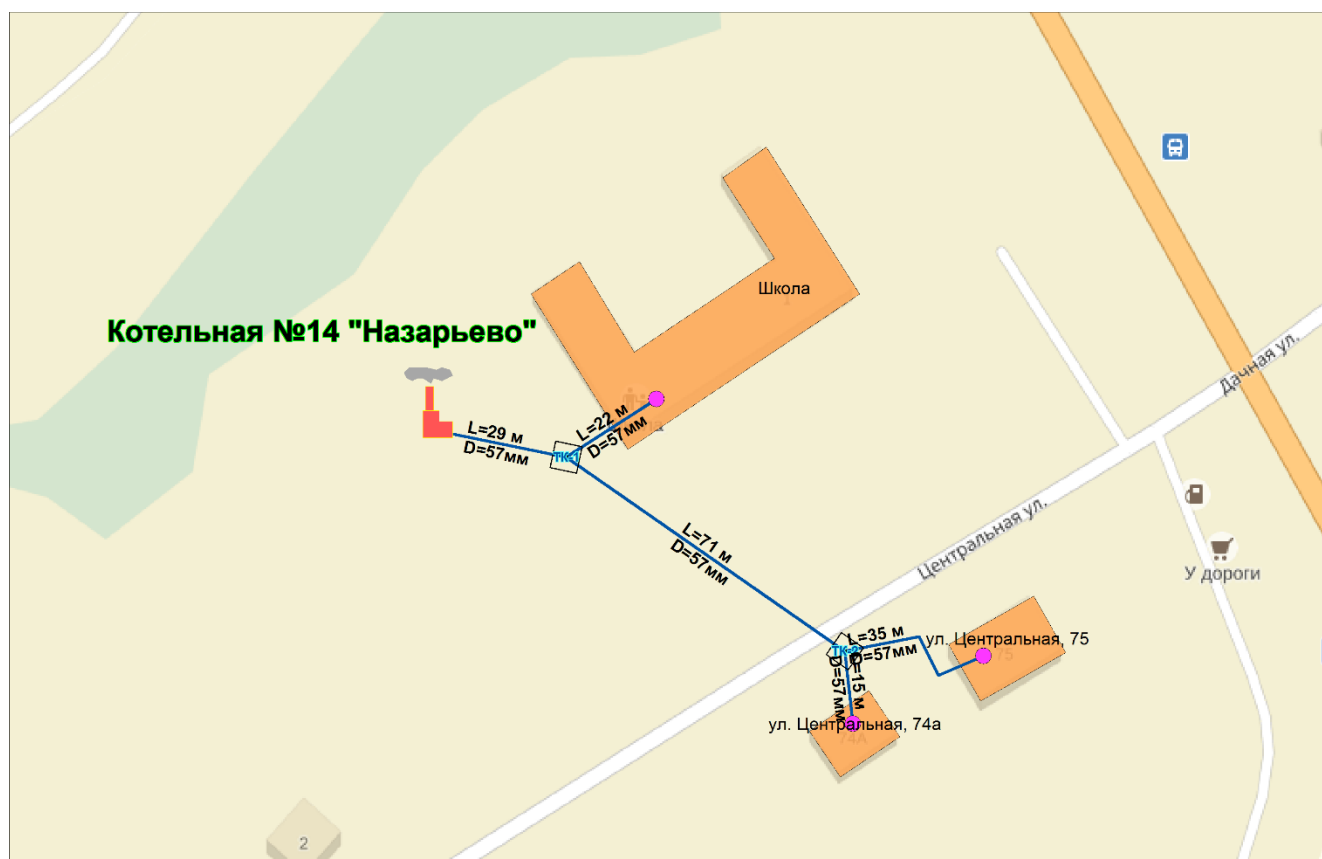
Рисунок 23 - Схема теплоснабжения д. Назарьево
