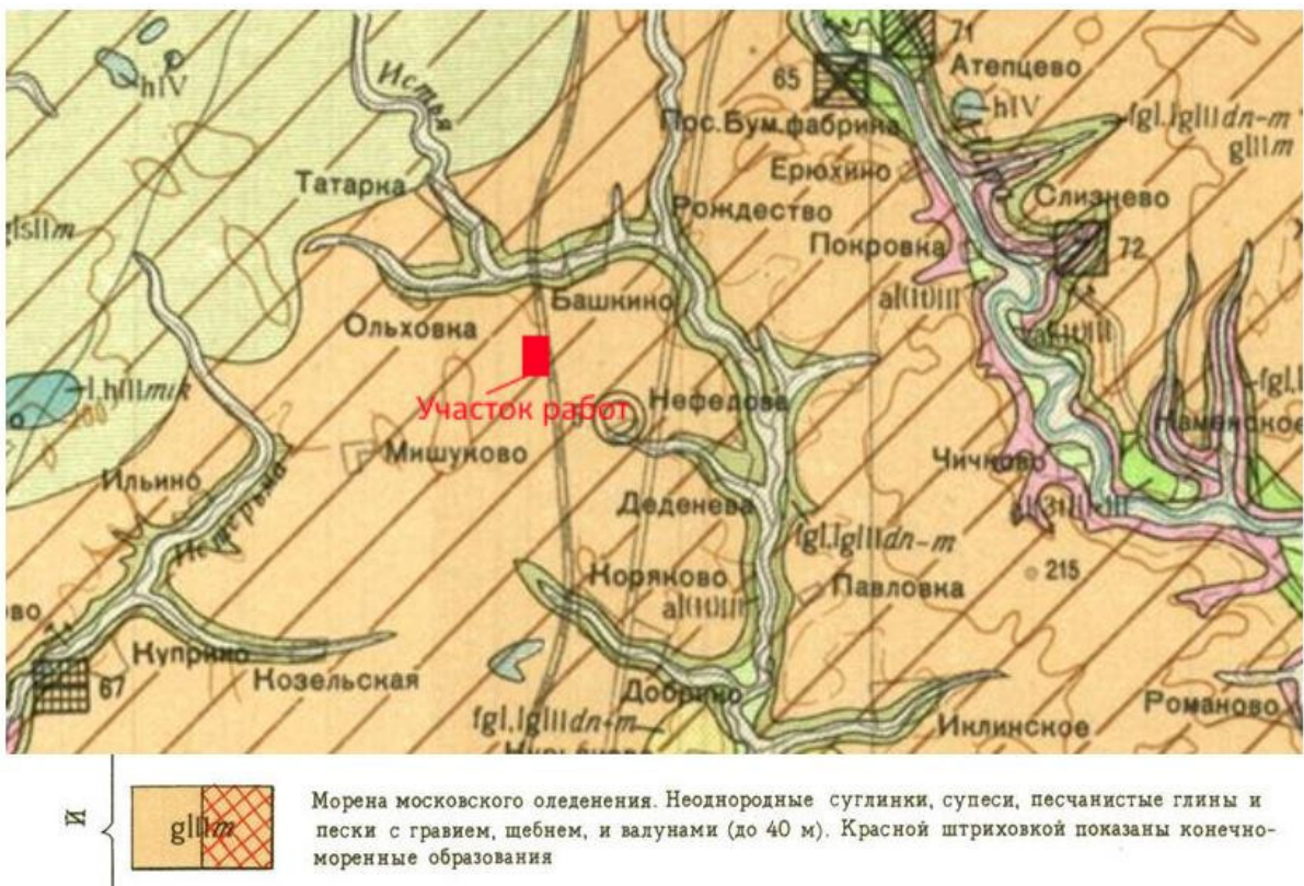
Рис.2. Вырезка из геологической карты масштаба 1:200 000, со схемой расположения участка работ.
