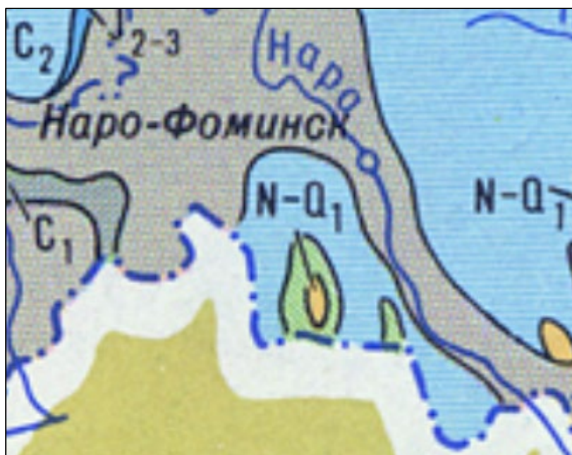
Рисунок 4.1 – Геологическая карта района изысканий ( J_{2-3} – Юрская система. Средний-верхний отделы. Глины, пески, песчаники; C_1 – Каменноугольная система. Нижний отдел. Известняки, глины, пески; C_2 – Каменноугольная система. Средний отдел. Известняки и доломиты с прослоями глин и мергелей, N-Q_1 – Неогеновая-четвертичная система. Глины, пески)
