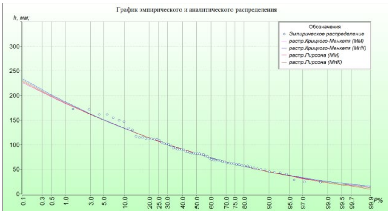
Рисунок 7.6 – Эмпирическое и аналитические распределения слоя стока весеннего половодья
