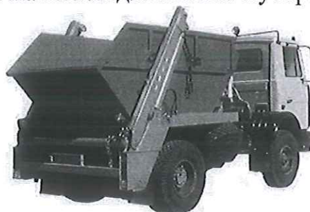
Рис. 4.16. Бункеровоз МКС-3501 на шасси МАЗ-5551А2
