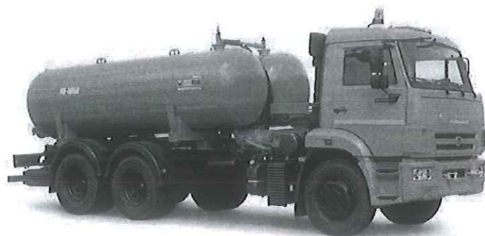
Рис. 5.1. Вакуумная машина КО-505А на шасси КамАЗ-65115-71
